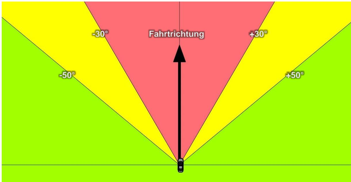
Abbildung 8: Definierte Sichtfelder eines Fahrzeugführers
